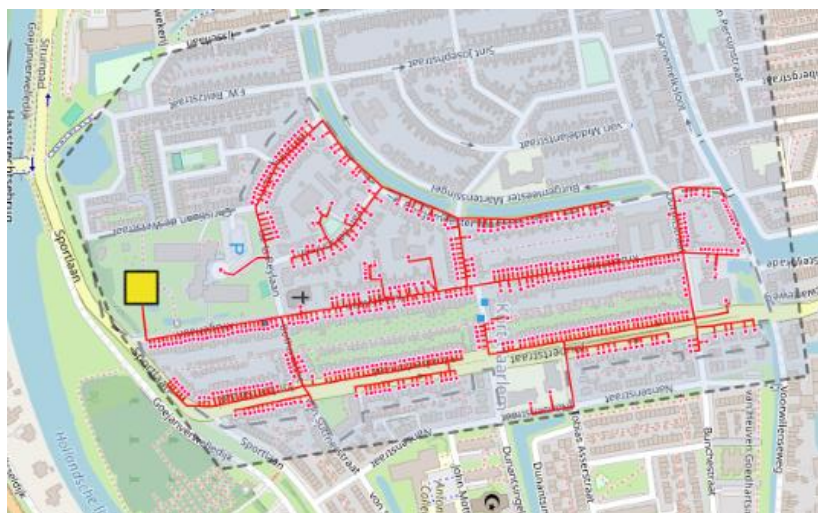
Afbeelding 5.1 Warmtenet ontwerp met energiecentrale (geel) aangegeven. Het ontwerp wordt in fase 2 herijkt
