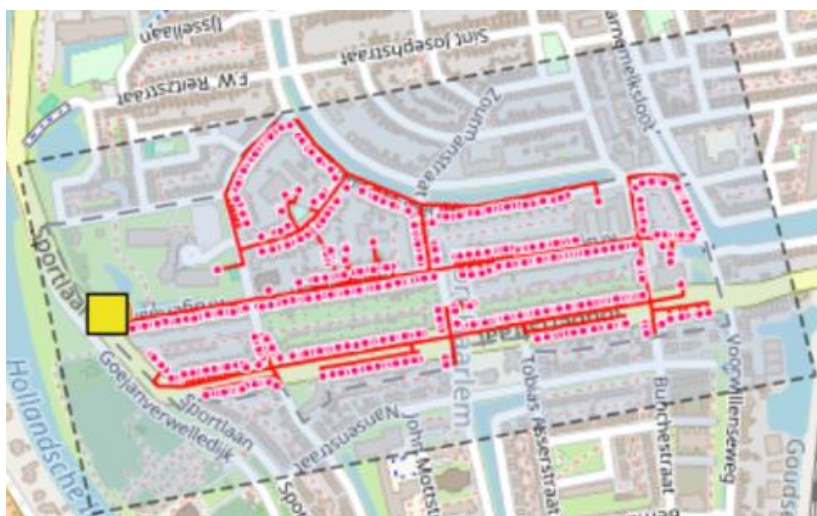
Afbeelding 4.2 Warmtenet ontwerp met energiecentrale (geel) aangegeven. Het ontwerp wordt in fase 2 herijkt.
